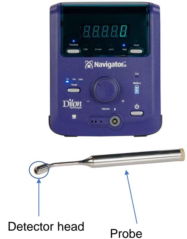
Fig. 3 Gamma Probe
